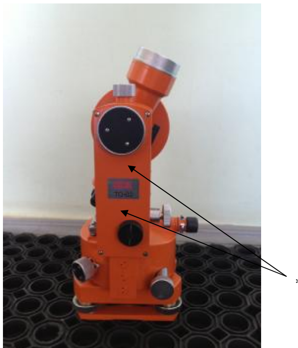
Рисунок 5 - Схема пломбировки от несанкционированного доступа
