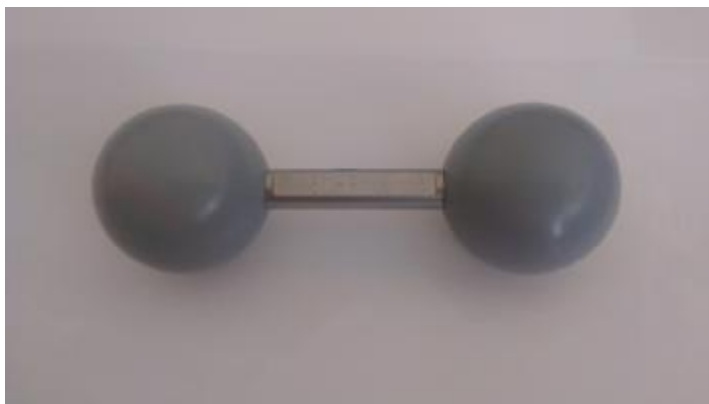
Рисунок 1 - Общий вид мер с шарообразными элементами
