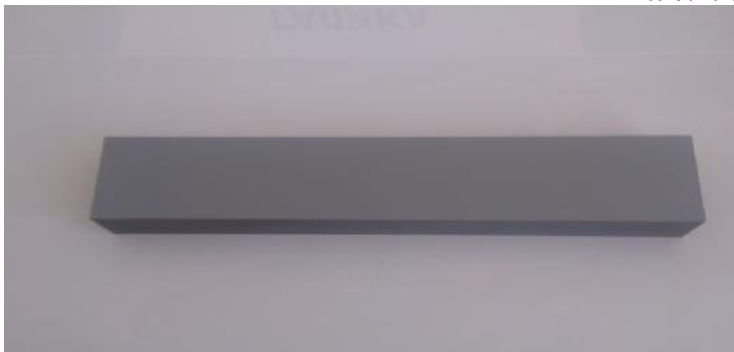
Рисунок 3- Общий вид меры отклонений от плоскостности
