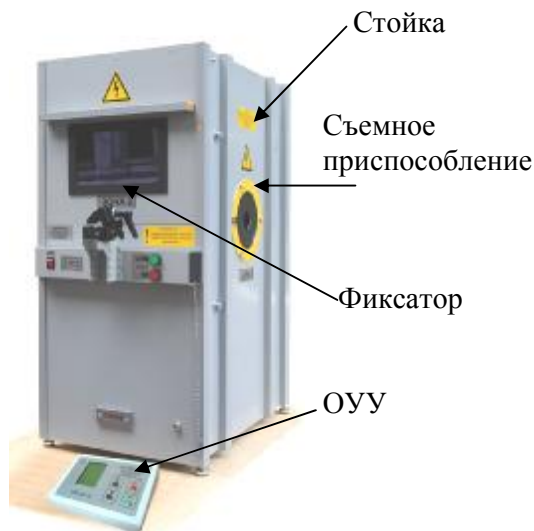
Рисунок 1 – Общий вид установки
