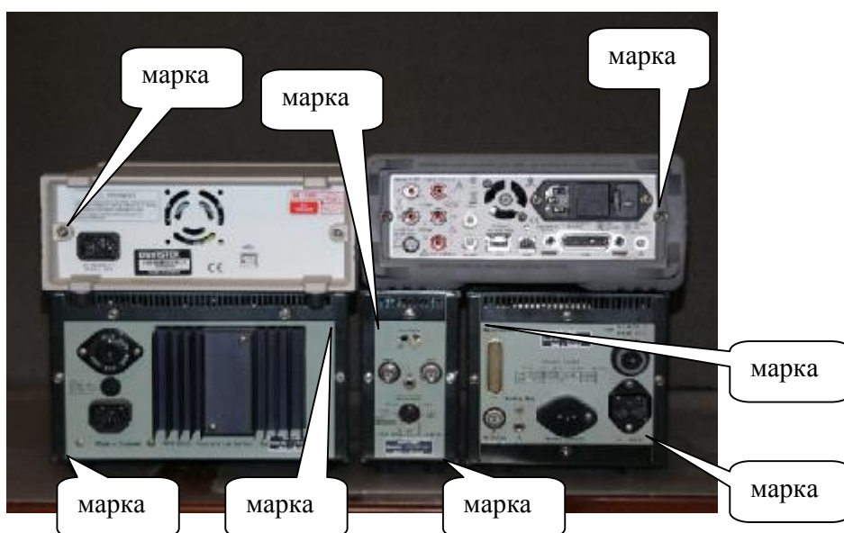
Рис. 2 Схема пломбировки от несанкционированного доступа, обозначения мест для нанесения оттисков клейм и нанесения наклеек
