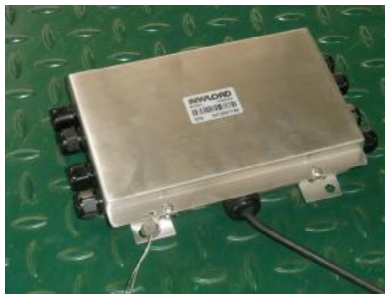
Рис. 4 – Место нанесения контрольного знака на блоке суммирования
