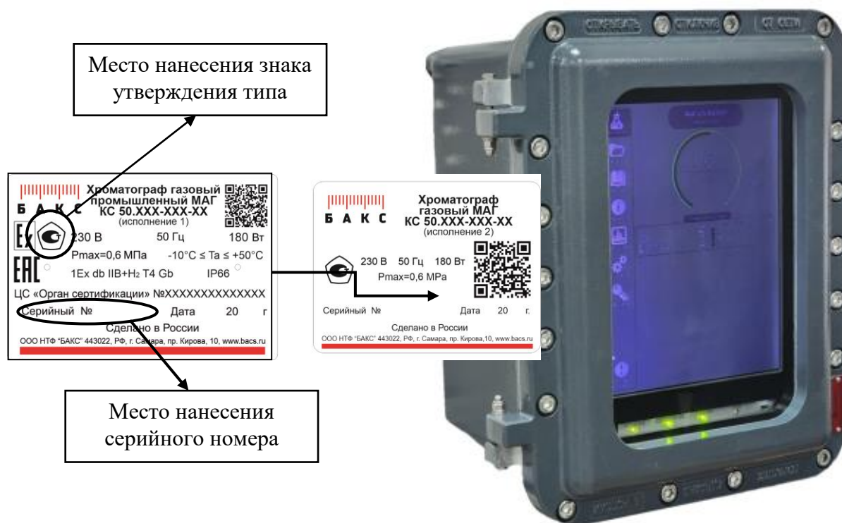
Рисунок 1 – Общий вид, место нанесения серийного номера и знака утверждения типа на хроматографы газовые промышленные МАГ модели КС 50.360-000, КС 50.360-000-01 и КС 50.310-000-01 во взрывозащищенном исполнении (исполнение 1) с сенсорным ЖК дисплеем и панелью светодиодов
