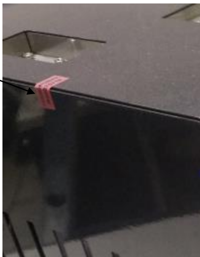
Рисунок 7 – Место пломбирования от несанкционированного доступа хроматографов газовых промышленных МАГ модели КС 50.310-000-01 в невзрывозащищенном (лабораторном) исполнении (исполнение 2)
