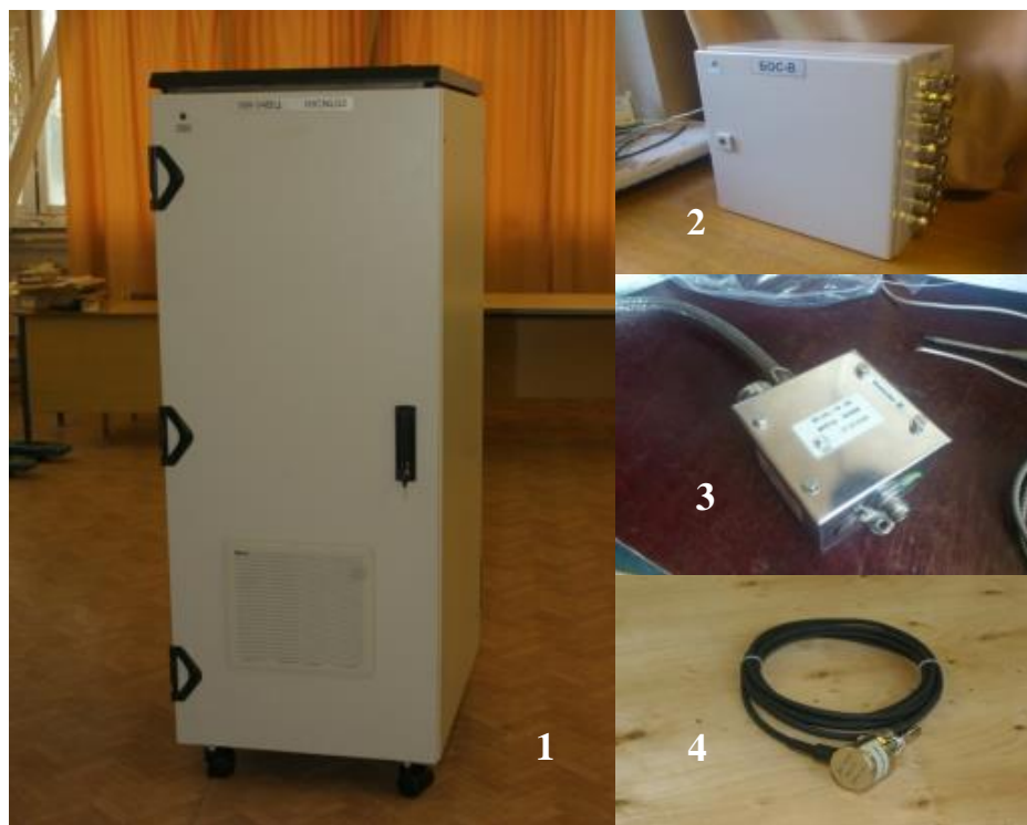
Рисунок 1 - Составные части системы СКТВ: 1) УИ-ххВЦ, УИ-14ВЦ (УИ-15ВЦ); 2) БОС-В; 3) Коммутационная коробка; 4) Зонд выносной СКТВ-ЗВ
