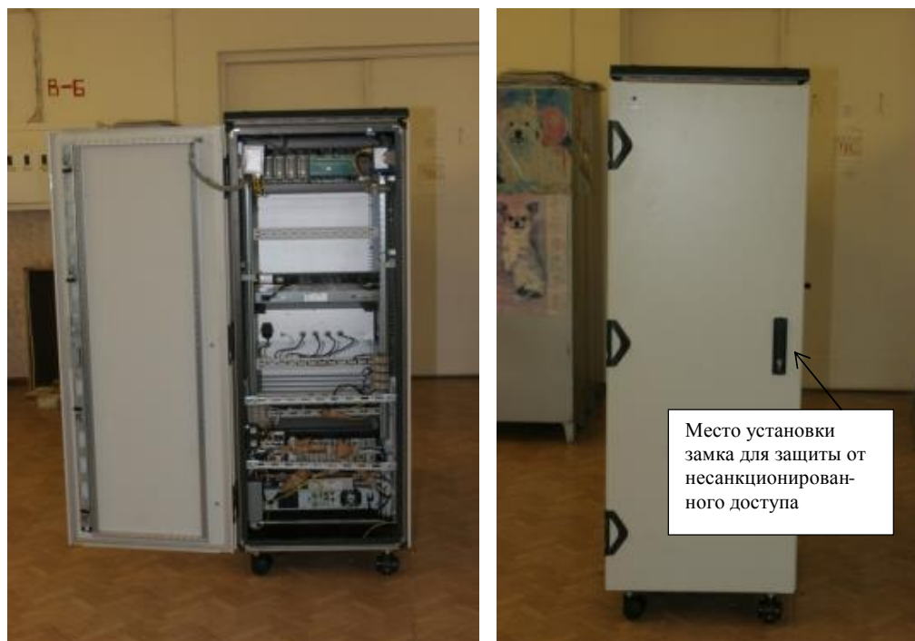
Рисунок 3 – Задняя стенка УИ-ххВЦ, УИ-14ВЦ (УИ-15ВЦ) в открытом и закрытом виде
