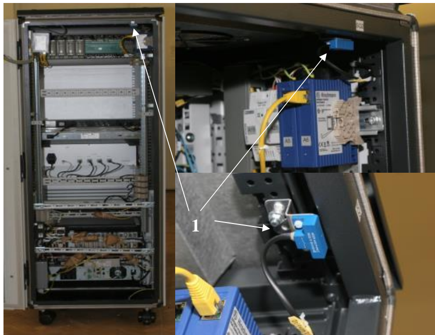
Рисунок 5 –Задняя стенка УИ-ххВЦ, УИ-14ВЦ (УИ-15ВЦ) 1 – датчик открытия двери, сообщает оператору системы об открытии двери
