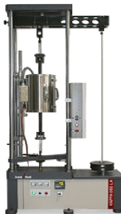
KAPPA 50 LA, KAPPA 100 LA (исполнение с нагружающим устройством рычажного типа с приложением нагрузки посредством грузов)
