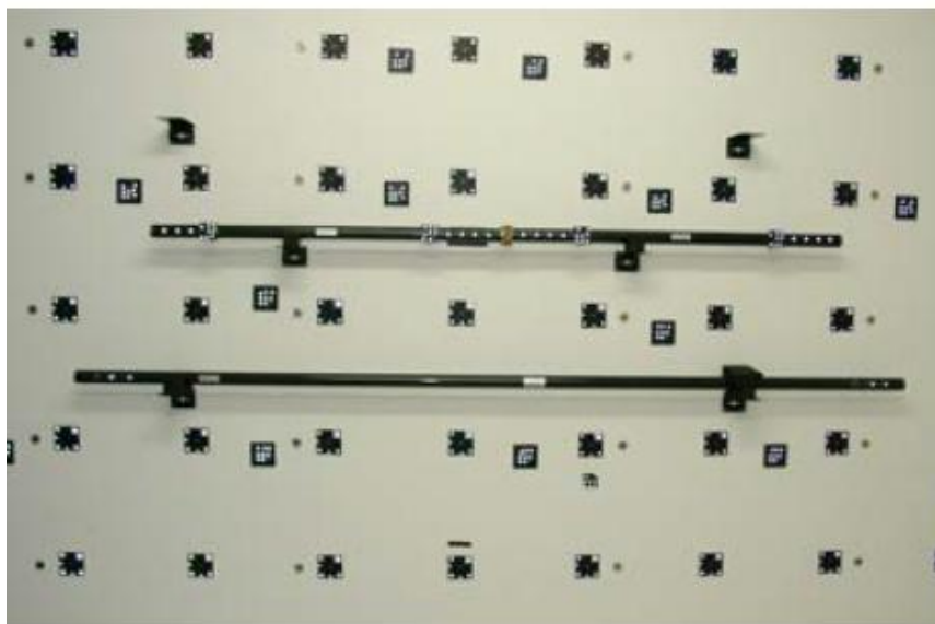
Рисунок 1 - Общий вид мер Scale Bar, закрепленных на стене.
