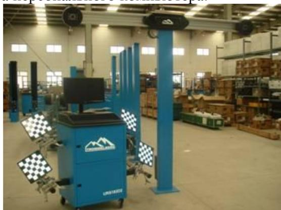
Фотография общего вида устройств для измерений углов установки колес автомобилей
