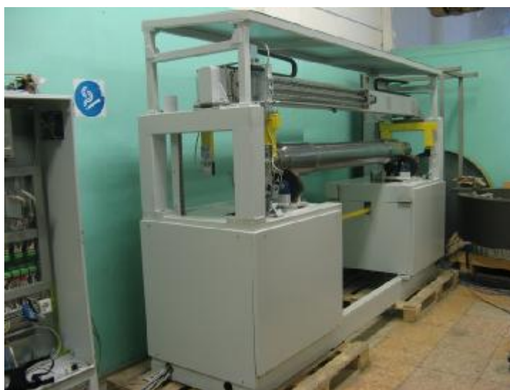
Рисунок 1 – Общий вид установок для измерений геометрических параметров осей РУ1Ш, РВ2Ш вагонов железных дорог «ГЕОМЕТРИКС-О»
