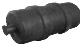
Рисунок 4 - Гиря массой 500 кг классов точности F_2 , M_1 , M_{1-2} , M_2 , M_{2-3} , M_3
