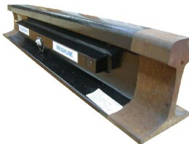
Рисунок 3 – Весоизмерительный тензорезисторный датчик весов исполнения WEIGHLINE
