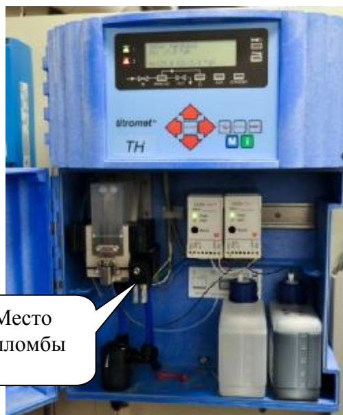
Рис.2 Анализаторы воды автоматические Testomat 2000, Testomat ECO, Titromat TH, Testomat 2000 CLT, Testomat 2000 CLF Вид пломбы.
