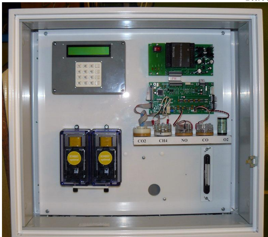
Рисунок 1 – Внешний вид газоанализатора КГА-8ЕС
