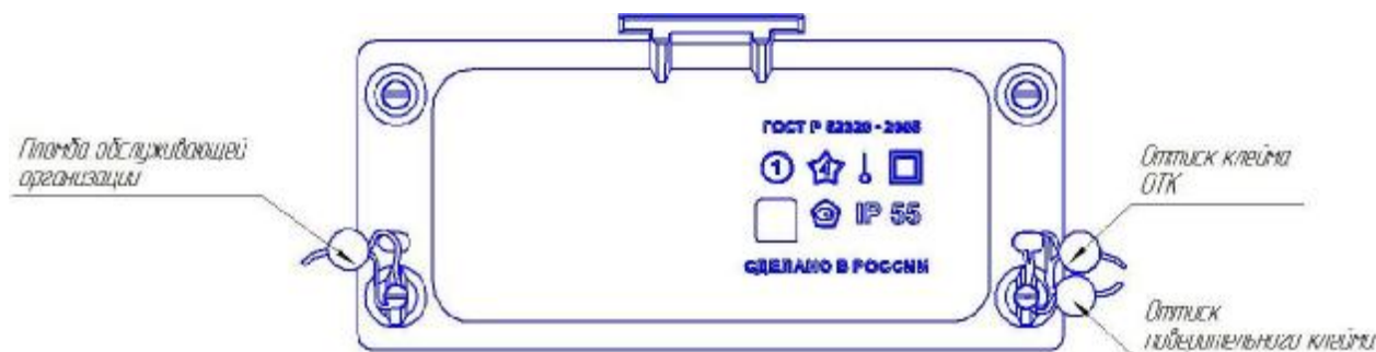
Рисунок 2 – Схема пломбирования счётчика
