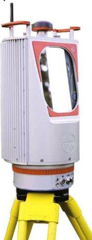
Фотография общего вида систем лазерных координатно-измерительных сканирующих VZ-4000, VZ-6000
