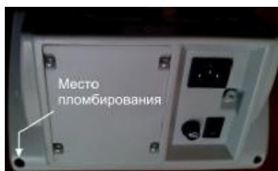
Рис. 2. Место пломбирования весов ВЭТ-1
