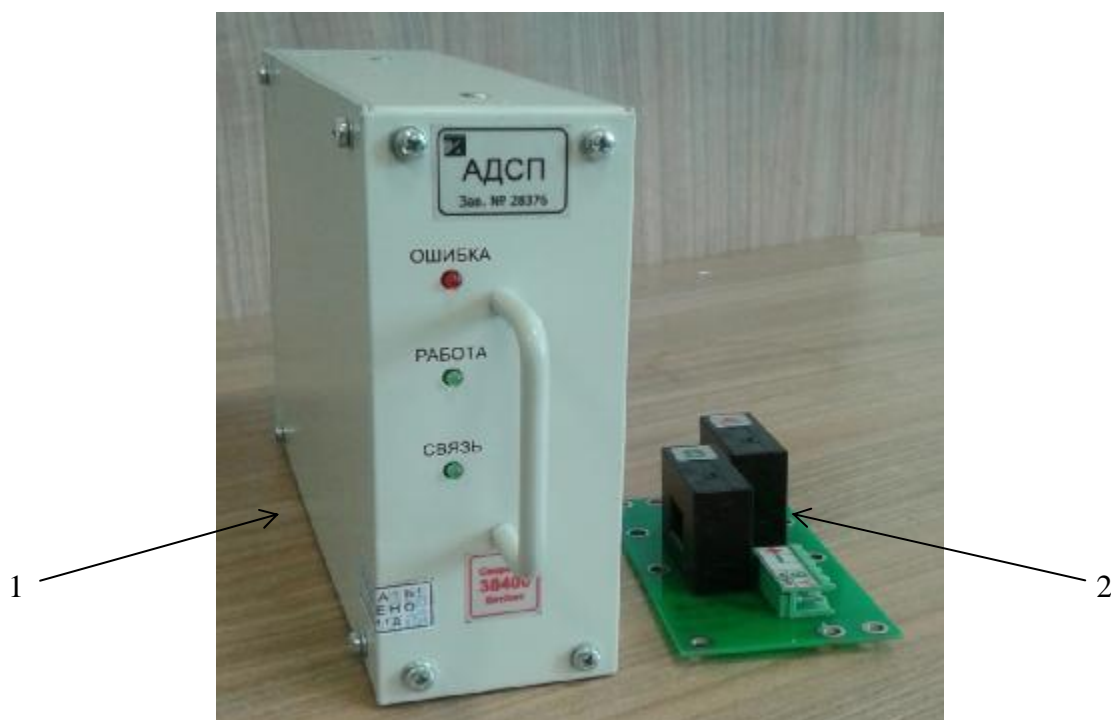
Рисунок 1 – Фотография общего вида автоматов диагностики силовых параметров стрелочного электропривода АДСП (1 - блок измерения и обработки, 2 - блок выносных датчиков тока)
