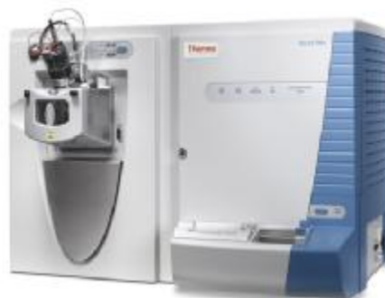
Рис. 4. Внешний вид детектора масс-спектрометрического Velos Pro.
