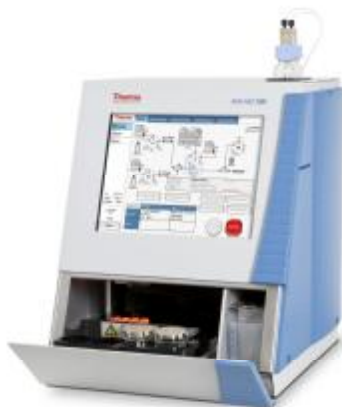
Рис. 1. Внешний вид хроматографа жидкостного EASY nLC 1000.
