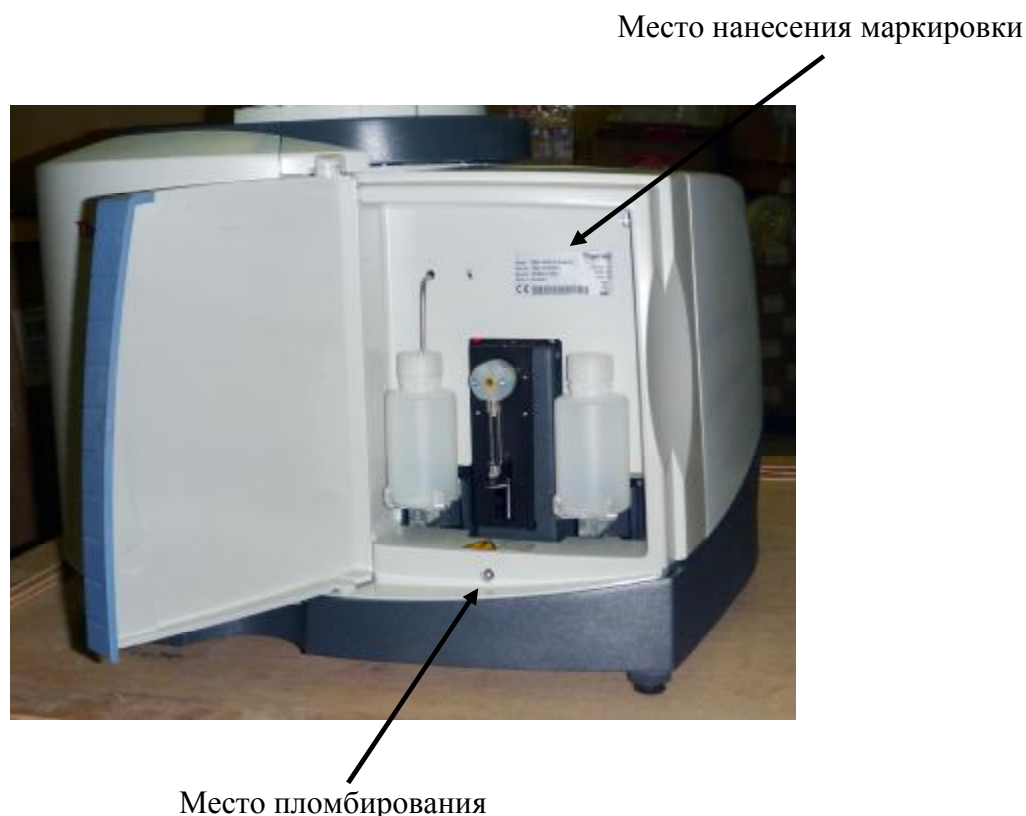
Рисунок 2 – Места нанесения маркировки и пломбирования
