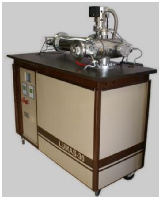
Рис.1 - Внешний вид масс-спектрометров «Люмас-30».
