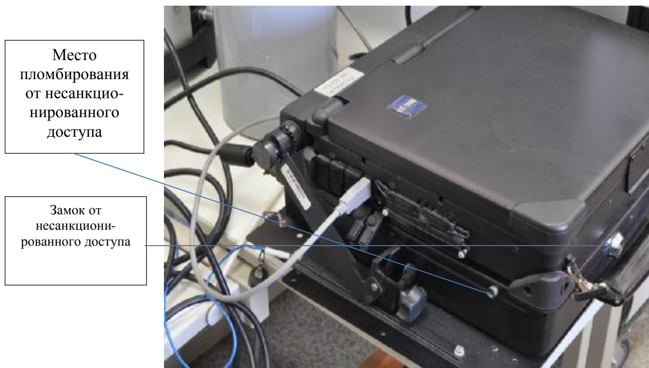
Рисунок 2 - Схема пломбировки КПА «Кварц Н» от несанкционированного доступа
