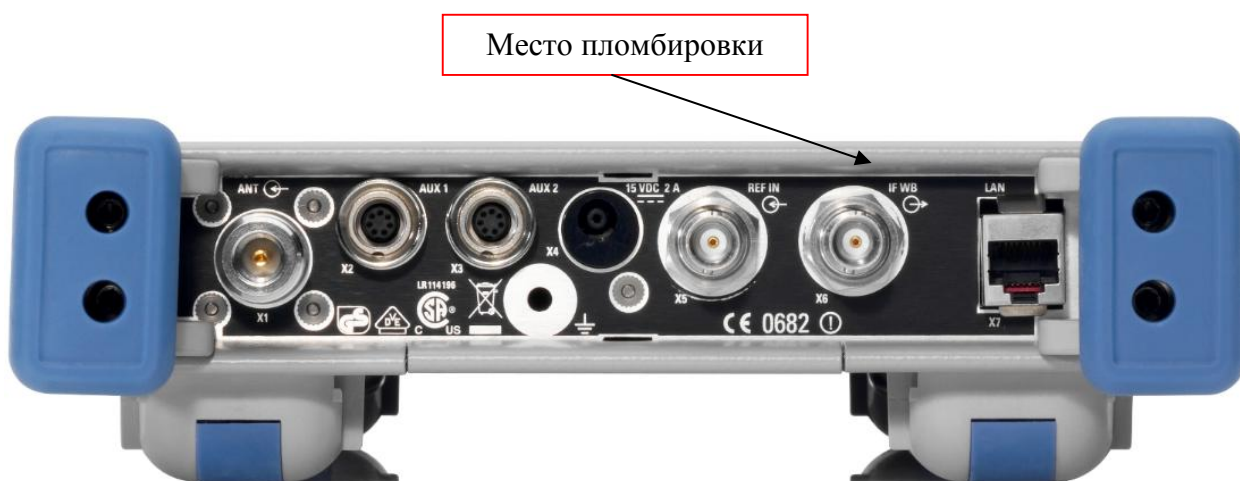
Рисунок 2 - Схема пломбировки от несанкционированного доступа
