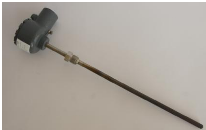
Рис.9 – Взрывозащищённый термопреобразователь ТХАУ-1087 (вариант с алюминиевой головкой и штуцером)
