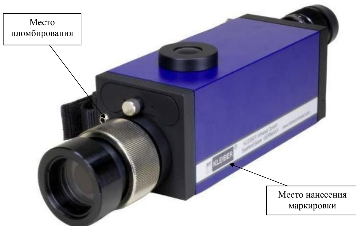
Рисунок 1 - Общий вид пирометров инфракрасных 414К и 414КГ с указанием места нанесения маркировки и места пломбирования
