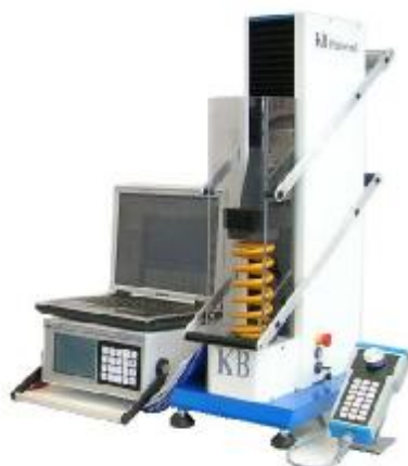
Рис.1.Общий вид машины для испытаний пружин KB 5000F, KB 2000F, KB 1000F
