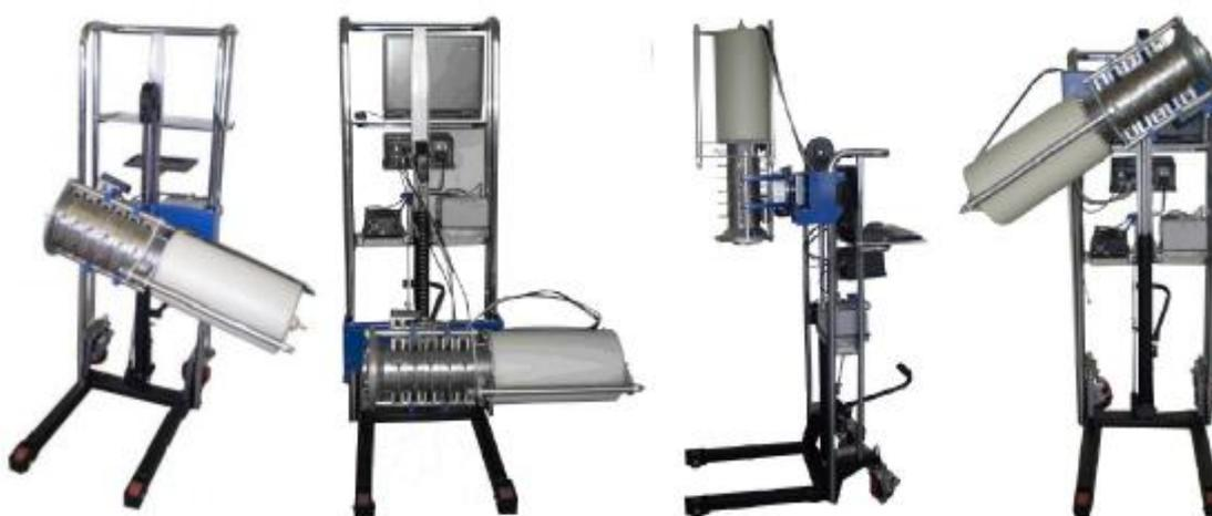
Рис.2 Внешний вид установки спектрометрической рентгеновского и гамма-излучения СЕГР-МСА527-ППД в комплектации с системой перемещения, позиционирования и коллиматорами.
