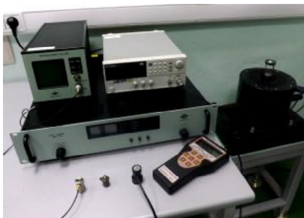
Рисунок 1- Внешний вид виброустановки поверочной ВУП-МГ4.01
