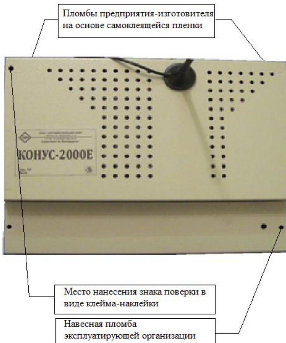
Рисунок 3 – Схема пломбировки УСПД с указанием места нанесения знака поверки
