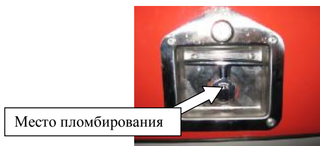
Рисунок 7 – Ручка открывания отсека для размещения узла выдачи топлива АТЗ
