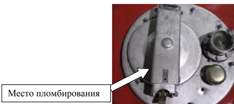
Рисунок 5 – Запорный механизм крышки заливной горловины АТЗ
