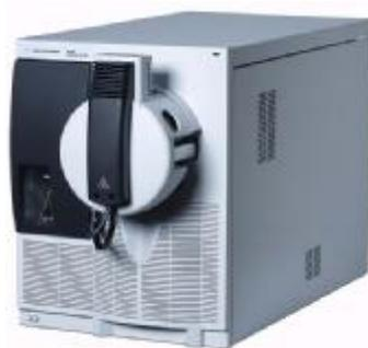
Рис.2. Внешний вид масс-спектрометров модели 6150 Quadrupole LC/MS
