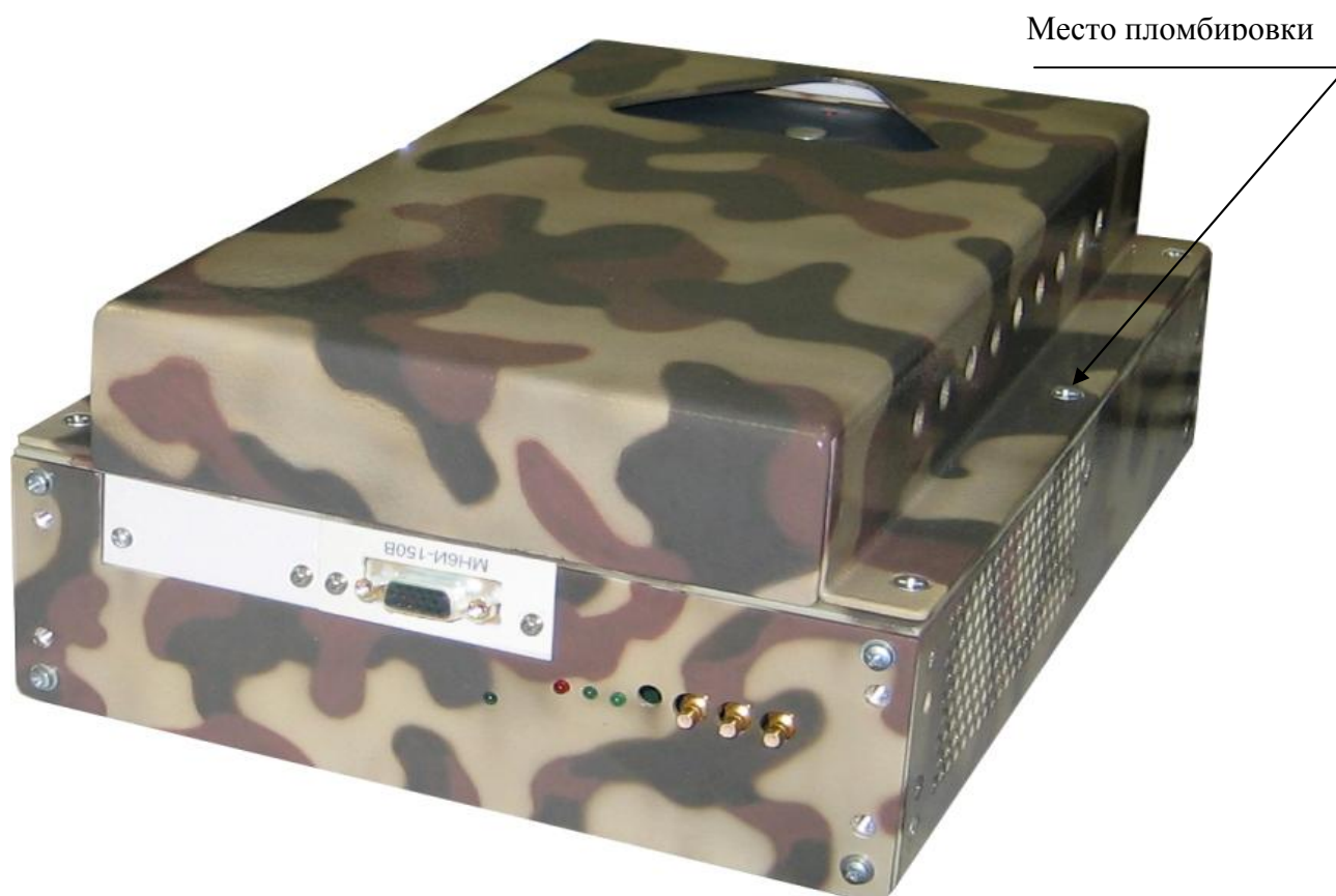
Рисунок 3 – Внешний вид устройства MezaBox с установленными измерителями и указанием места пломбировки
