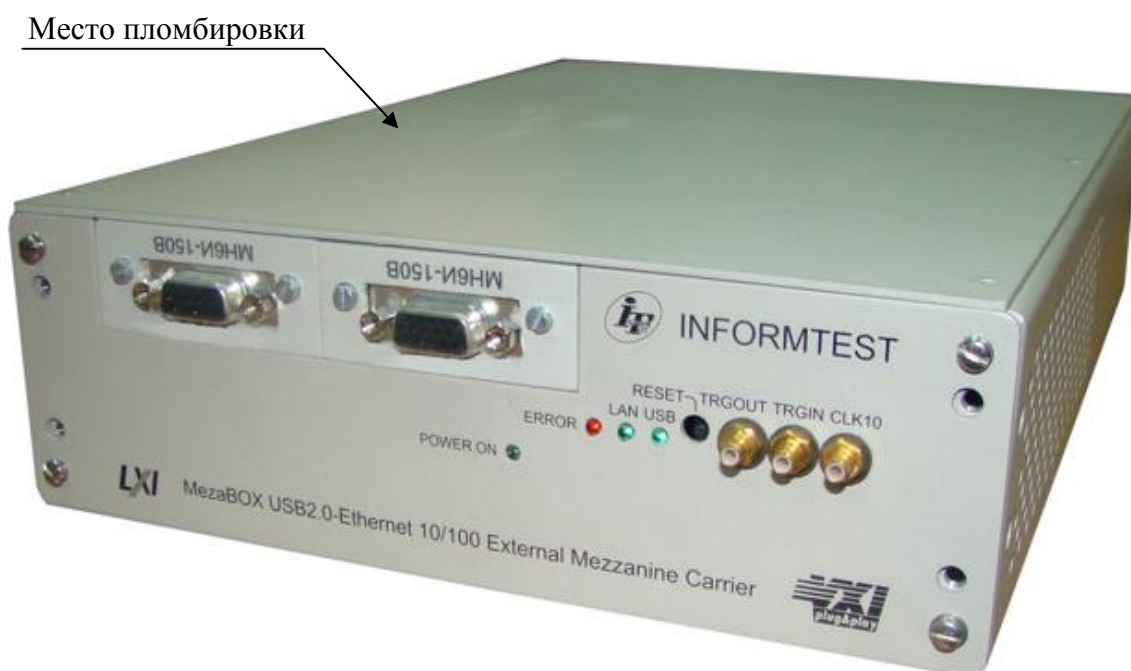
Рисунок 3 – Внешний вид устройства MezaBox с установленными измерителями и указанием места пломбировки
