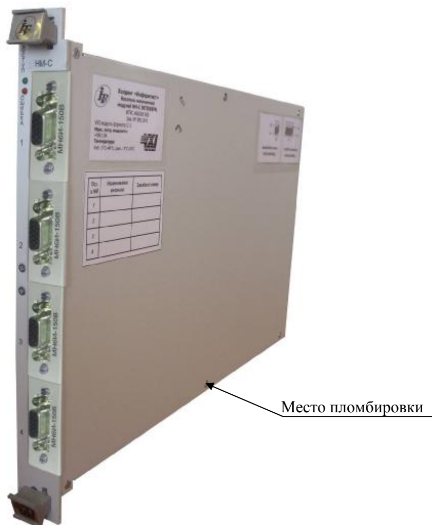
Рисунок 2 – Внешний вид носителя мезонинных модулей типа НМ-С (НМ, НМ-М) с установленными измерителями и указанием места пломбировки
