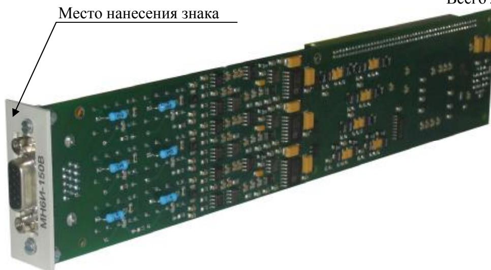
Рисунок 1 – Внешний вид измерителя с указанием места нанесения знака утверждения типа
