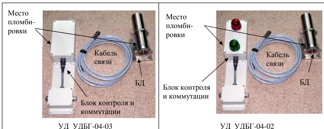
Рисунок 2 - Внешний вид комплекса СКРО-01А-02 и мест пломбировки
