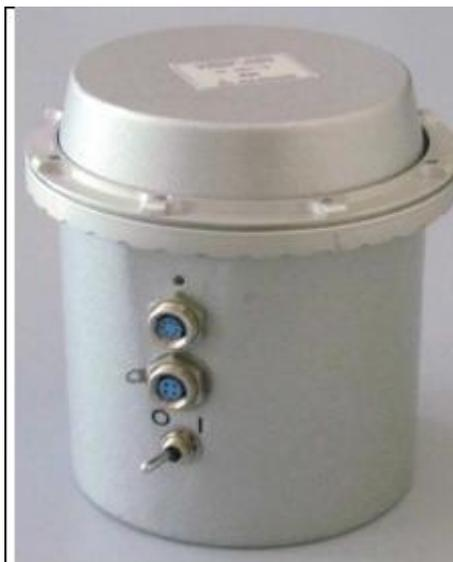
Рисунок 6 - Внешний вид устройства детектирования гамма-излучения УДБГ-04-06 (УДКГ-А01)
