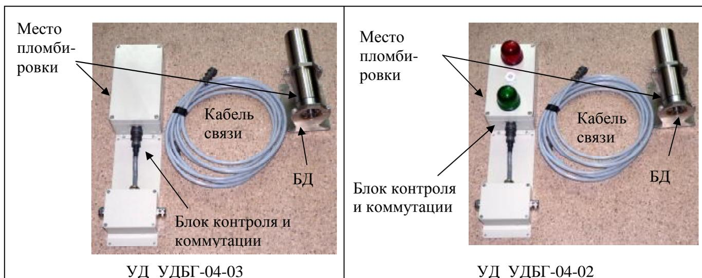
Рисунок 2 - Внешний вид комплекса СКРО-01А-02 и мест пломбировки
