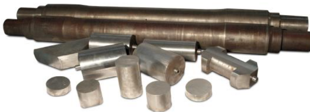
Рисунок 1 – Внешний вид комплекта образцов искусственных дефектов «КОИД-САУЗК-ОС-1»
