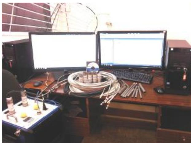
Общий вид дефектоскопов вихретоковых MIZ-85iD-2
