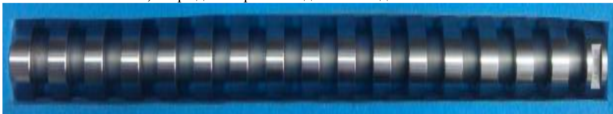
б) Мера диаметром от 7 до 60 мм и длиной 170 мм
