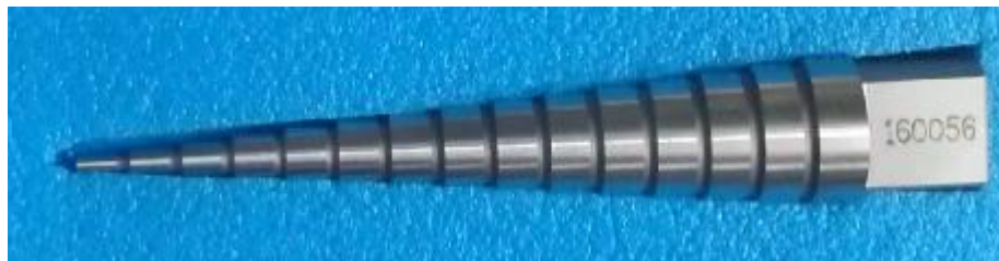
а) Мера диаметром от 2 до 16 мм и длиной 105 мм
