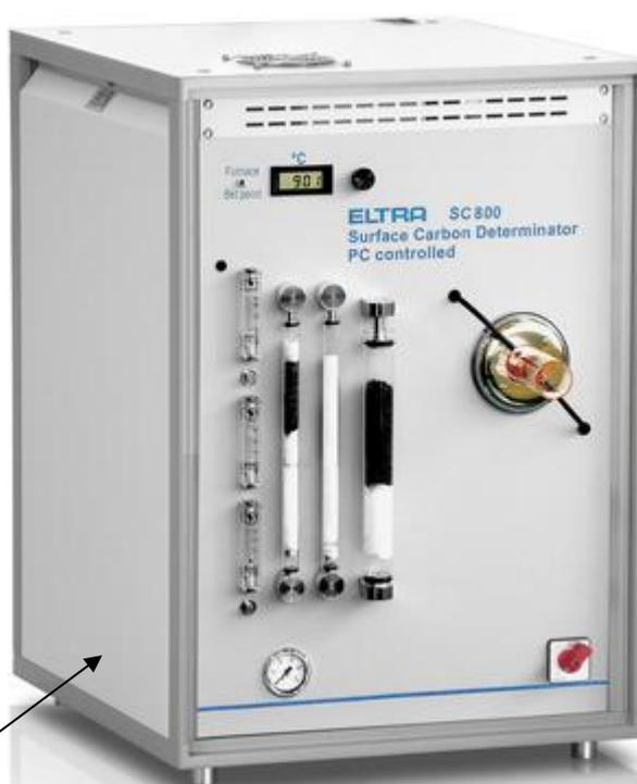
Место нанесения поверительного клейма (или знака поверки в виде наклейки)
