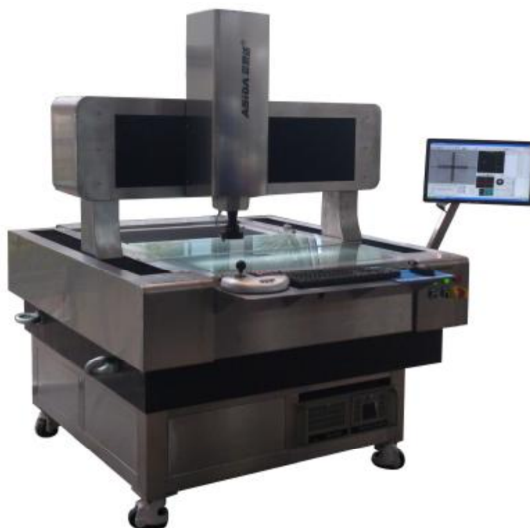
Рис.1 Внешний вид приборов для автоматического измерения размеров печатных плат и фотошаблонов ИММ
