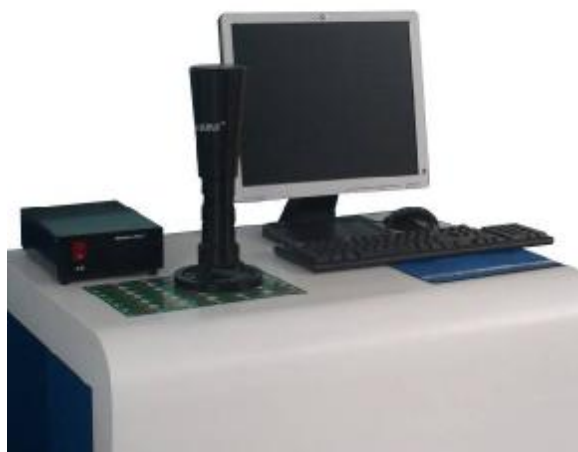
Рис.2 Внешний вид приборов для автоматического измерения ширины проводников ХК13
