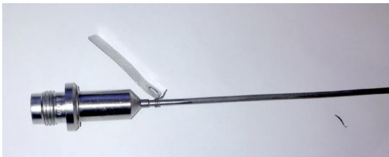
Рис.1 Преобразователь термоэлектрический ТХА-12 (исполнение без защитной головки)
