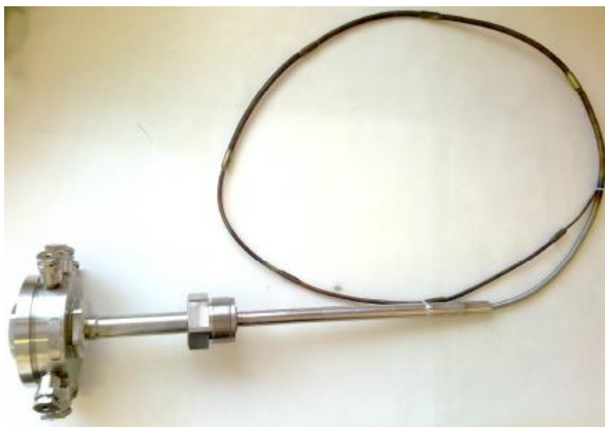
Рис.1 Преобразователь термоэлектрический ТХА-14 (исполнение с защитной головкой)
