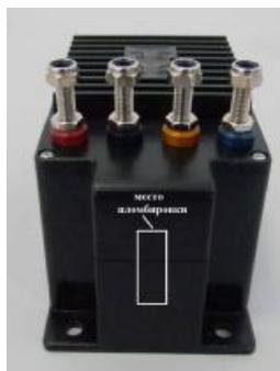
Рисунок 1 – Внешний вид и схема пломбирования датчиков
