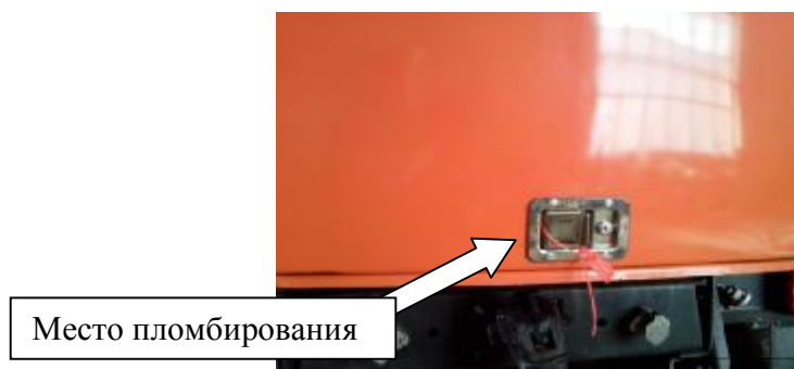
Рисунок 6 – Ручка открывания отсека для размещения узла выдачи топлива АТЗ
