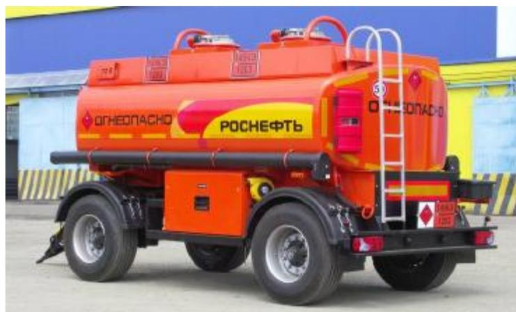
Фото 1. Общий вид прицепа-цистерны ГРАЗ-ПЦ-10,7 М1Г1
