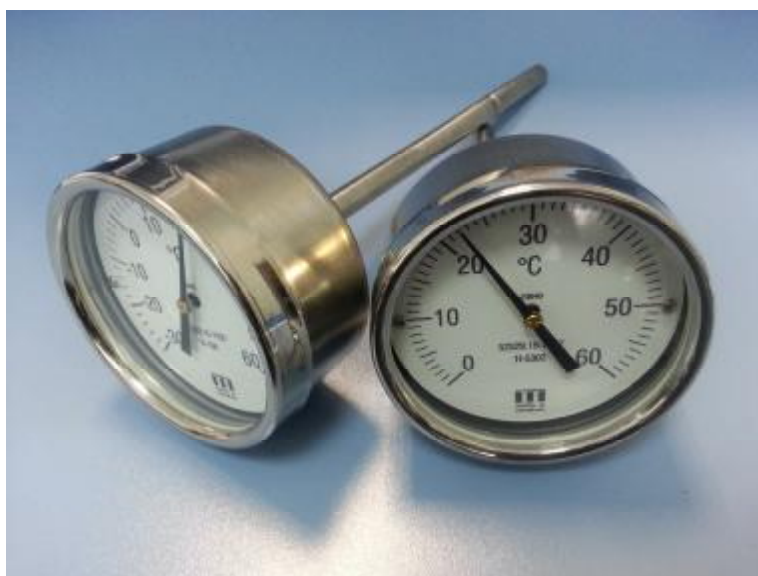
Рис. 1. Термометры манометрические модели Н207.
