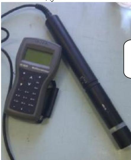
Рис.1. Внешний вид анализаторов гидрохимических НІ 9829, НІ 98290.
