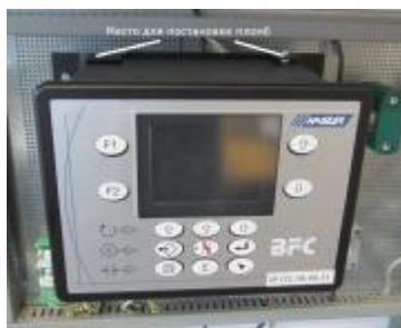
Рис.1 – Внешний вид и схема пломбирования контроллера ВФС.
