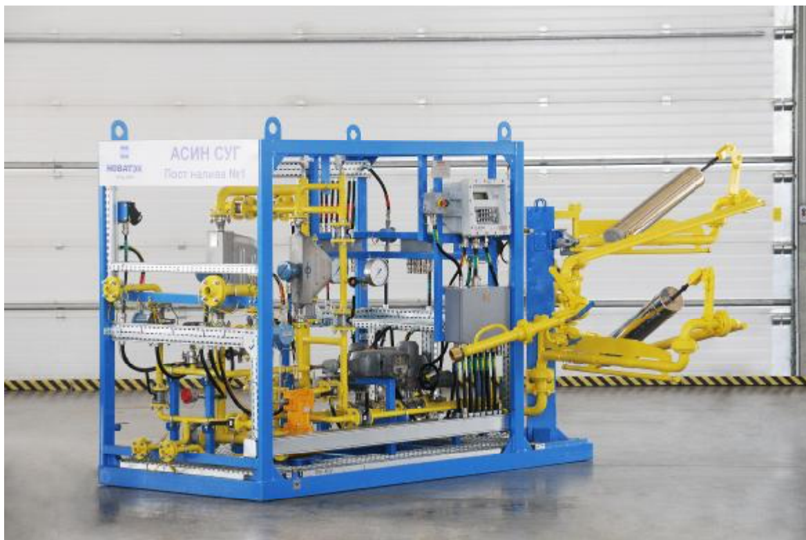
Рисунок 1 – Общий вид системы измерения массы сжиженных углеводородных газов при наливе в автоцистерны автоматизированной АСИН СУГ
